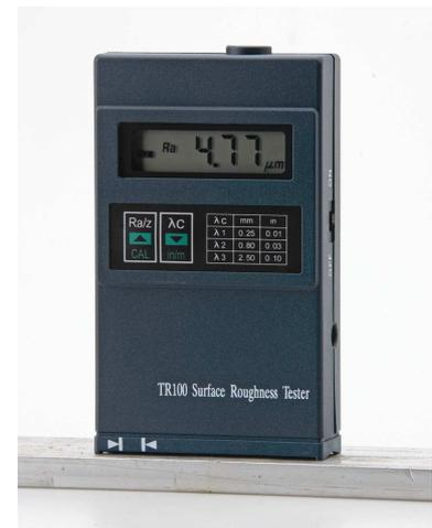
parameter. Er ist der arithmetische Mittelwert der Profilabweichungen von der Mittellinie. Der Zahlenwert Ra ist immer kleiner als der auf dem Rauheitsprofil ermittelte Rz-Wert.
