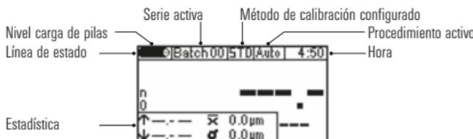
En la primera puesta en marcha están preconfigurados la serie de medición 00 (“Batch 00”) y la calibración de fábrica (“STD”). Ambos ajustes se presentan en la línea de estado.
